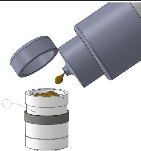
Figura 2: Fase de llenado de la tapa con electrolito en gel.
