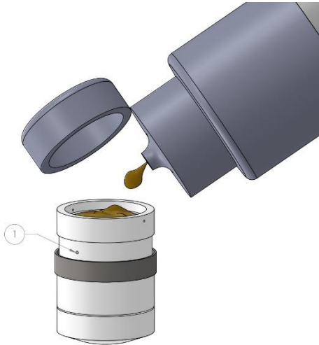
Figura 4: Fase di riempimento del cappuccio con l'elettrolita gel.
