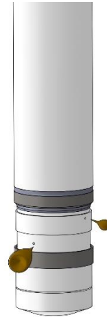
Figura 5: Fase di montaggio del cappuccio sulla sonda
